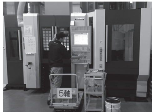
写真3 DMG森精機を中心に5軸加工機は横形MCと立形MCを合わせて6台を使用。SCHUNK社製バイスなどを使って24時間体制で加工を行う
