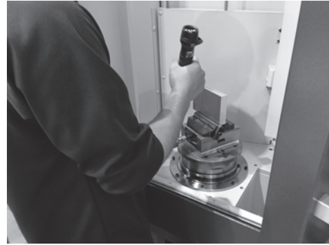
写真7 トルクレンチによる操作でワークの脱着が簡易に行える
